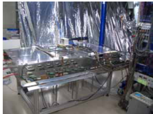
PDC+KDC12 の試験配置： 図に 2 台のトリガー用シンチレータは省略。
