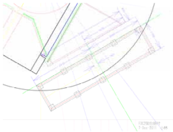
架台設置位置
